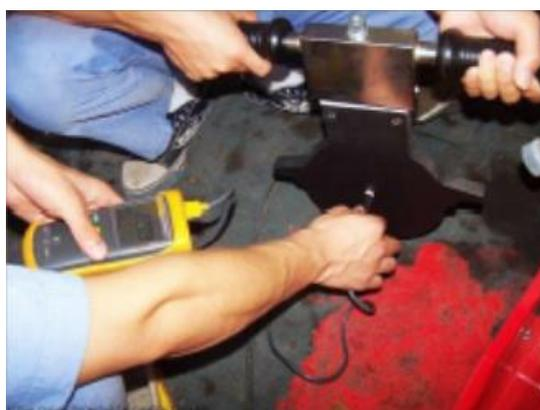
4. В такой ситуации, мы должны устранить отклонение температуры регулятора (отклонение температуры составляет 24 градуса, т.е.  $196 - 220 = -24$ )
