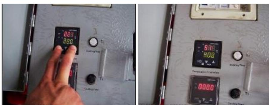
Нажмите кнопку "SET" дважды, на дисплее отобразится нижеследующий рисунок. Если начальная температура для корректировки составляет 5 градусов, то для корректировки температуры вводим нижеследующие данные:  $5 + (-24) = (-19)$  градусов.
