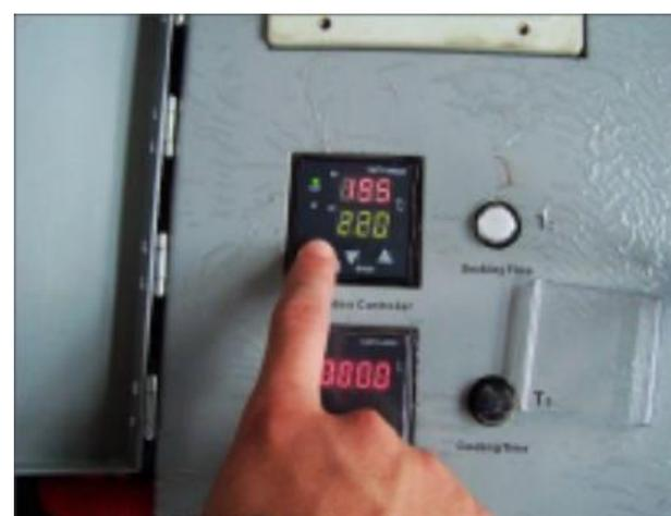
При стабильной температуре 220 градусов на дисплее, повторно проверьте температуру поверхности нагревательного элемента. Если все еще существует отклонение температуры, то повторите описанную выше операцию по корректировке температуры еще раз.
