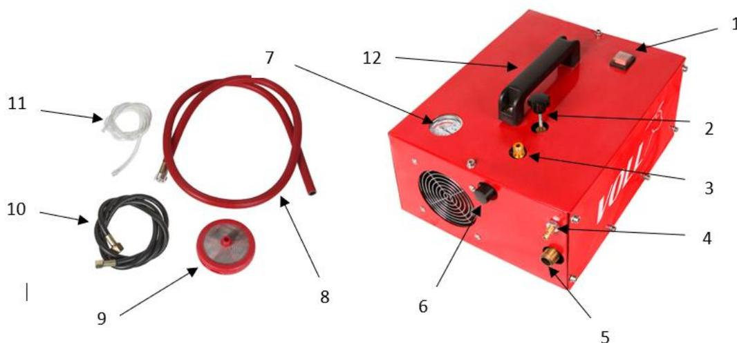
1-кнопка вкл/выкл, 2-вентиль регулировки давления V1, 3-штуцер подсоединения РВД, 4-штуцер подсоединения обратного шланга, 5-штуцер подсоединения шланга подачи воды, 6-кран сброса давления V2, 7-манометр, 8-шланг подачи воды, 9-фильтр, 10-рукав высокого давления (РВД), 11-обратный шланг, 12-ручка для переноски.
