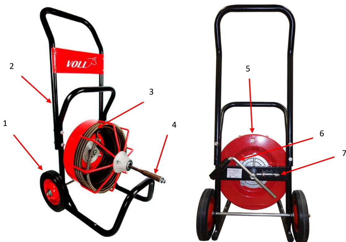
1-Резиновые колеса; 2-Разборная стальная рама; 3-Неразборная прочистная спираль диаметром 13 мм и длиной 15 м.; 4-Наконечник прочистной спирали с Т-образным замком диаметром 22 мм.; 5-Съемный барабан для прочистной спирали; 6-Ручка вращения барабана; 7-Фиксатор барабана.
