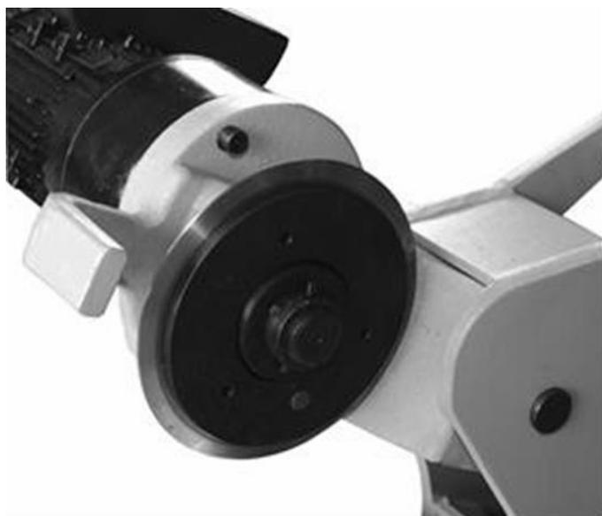
3. Снимите изношенный режущий диск и установите новый
