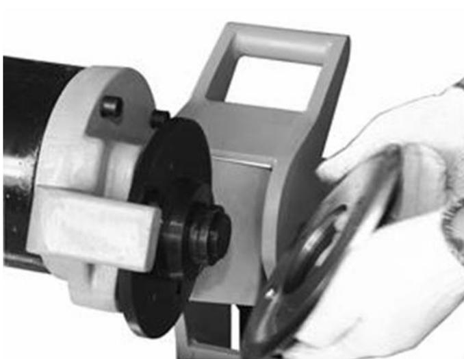
4. Установите винты на место, режущий диск должен легко и свободно вращаться в любом направлении. Установите на место защитный кожух режущего диска.
